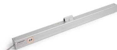
Ketjuavaajat JIS-ACT-CM 24 VDC, 1-2A, IP 20-22, 150-400N 230 VAC, 0,5-0,7A, IP 20-22, 150-400N 200-835 mm
